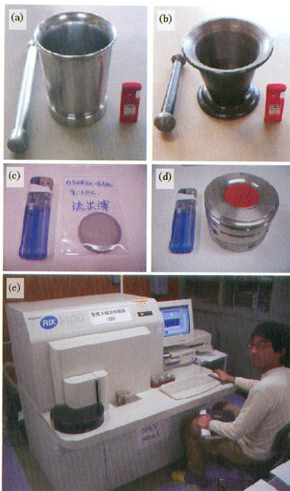
写真2 (a)ステンレス鉢、(b)鉄鉢、(c)円盤状ペレット、(d)分析用ホルダー、(e)本研究で使用した蛍光X線分析装置RigakuRIX3100。
